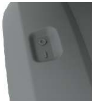
Interruptor de protecció
